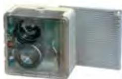
Rivelatore lineare di fumo, composto da un'unica unità ottica (TRX) e da un riflettore. Raggio di protezione compreso tra 2 e 50 metri. Regolazione dell'intensità del fascio, in funzione della distanza. Controllo automatico del guadagno per compensazione perdita del segnale a causa impolveramento. Facile allineamento senza strumenti esterni a mezzo di led. Certificato CPR in accordo alla normativa EN 54 parte 12.
