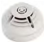
Rivelatore ottico indirizzabile di colore bianco senza base. Costituito da una camera ottica sensibile alla diffusione della luce. Dotato di protocollo digitale avanzato che garantisce maggiori possibilità di gestione, capacità e flessibilità. Doppio led tricolore (rosso, verde e giallo) per visualizzazione a 360° programmabile lampeggiante o fisso. Indirizzamento a mezzo di selettori rotanti. Dotato di isolatore di corto circuito. Certificato CPR in accordo alla normativa EN 54 parte 7 e 17.
