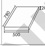
**5** **PGE9025** - paracolpi piano rigato mm 780 x 500 x h 20 colore giallo/nero, spessore 20 mm, peso kg 1,9, senza biadesivo
